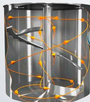
Движение вверх по периферии смесительной камеры, опускание вниз в центральной части резервуара
